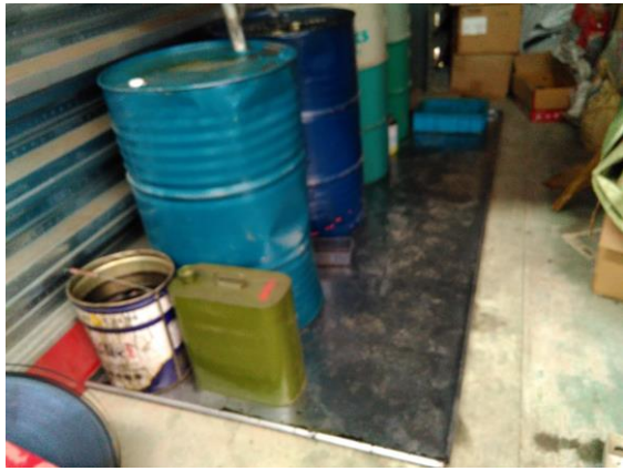
危废暂存间：废切削液、机油注入油桶，油桶放入接油盆
